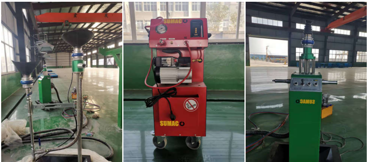
图 4-5 移动戳孔放油机、气动抽接油机、冷媒真空回收机
